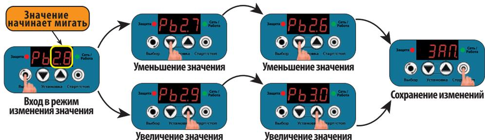
24.3 “PCX.X” – давление “сухого хода”. Реле **выключит насос** с целью защиты его от “сухого хода”, если давление в системе будет находиться **ниже уровня “PCX.X” в течение времени, установленного параметрами “СХХХ”** (п. 24.4, стр. 18) или “с-XX” (п. 25.2, стр. 19). **Не может быть установлено выше, чем “РНХ.X” – 0.2 бара** (минус 0.2 бара).
