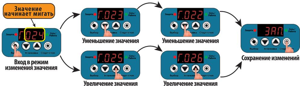
25.8 "td.XX" – интервал неизменности давления в секундах (функция "дельта"). Если при работающем насосе, давление в системе не меняется более чем на 0.3 бар в течение "td.XX", то насос будет отключен, а на дисплее выводится "dXX.A" ↔ P X.X, где "XX" – номер остановки, а "X.X" – давление в системе, например: **00.18** ↔ **P 2.9**.
