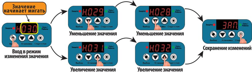
25.5 “nH.XX” – количество последовательных отключений насоса по функции “недобор давления”, при давлении в системе выше уровня “РНХ.X” (п. 24.1, стр. 17) до перехода РДЭ в режим аварии **Н-Е**. Последовательными считаются отключения, если между ними насос не выключался по уровню “РbX.X” или по какому-либо аварийному режиму, а также работа РДЭ не была прервана нажатием кнопок “Старт/стоп” или “Выбор”.
