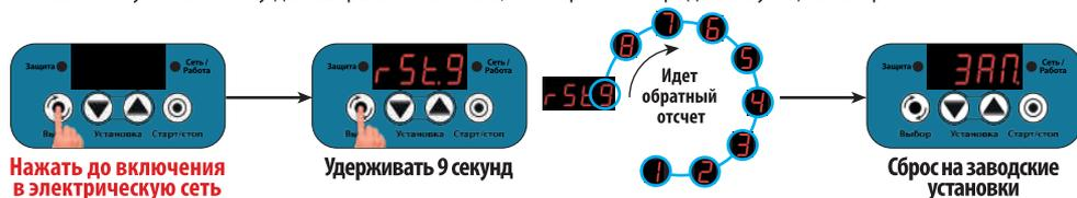
**Нажать до включения в электрическую сеть**
