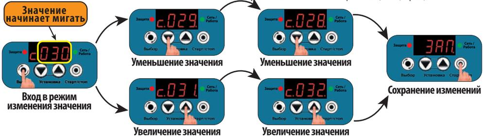
26.3 “nC.XX” – количество циклов автоматического перезапуска насоса после срабатывания защиты по сухому ходу для режима “rC.02” (п. 26.1, стр. 26). Насос перезапустится “XX” раз для проверки появления воды в источнике до достижения давления в системе уровня “PCX.X”.
